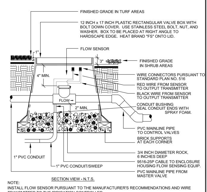
TRANSMITTER TO THE IRRIGATION CONTROLLER.
